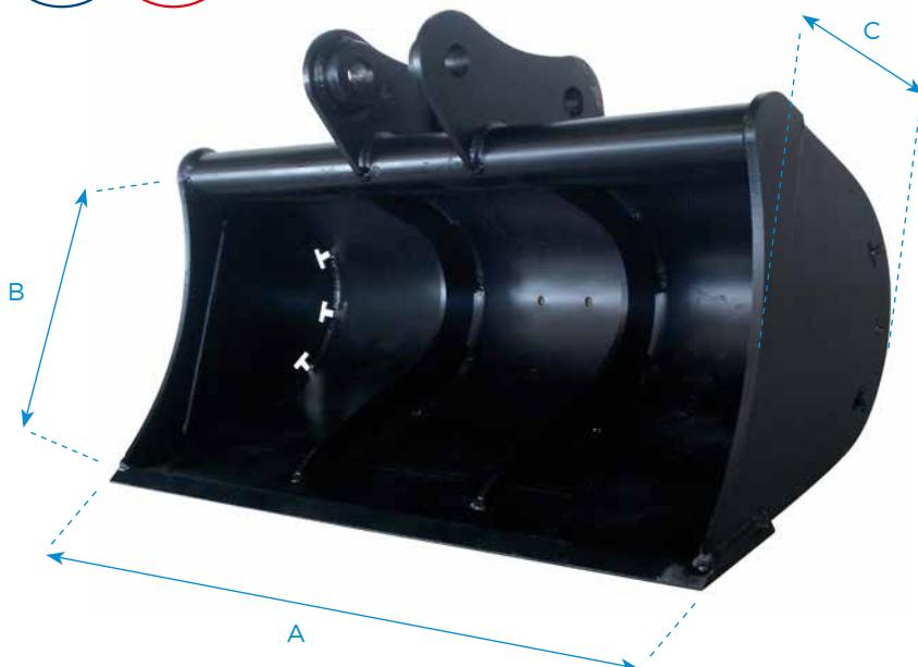
Indicata per la **pulizia e la manutenzione delle scarpate dei canali di scolo delle acque**, per opere di bonifica ambientale, consigliata per tutti i lavori di mantenimento delle scarpate è dotata di fori di scarico sulle fiancate e sul fondo.
